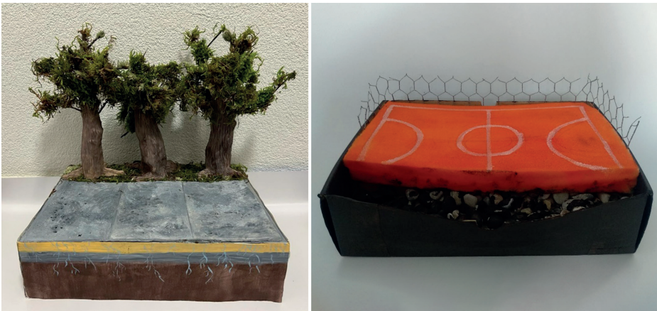
Links: Prototyp der chaussierten Parkplätze. Rechts: Prototyp des sickerfähigen Hartplatzes
